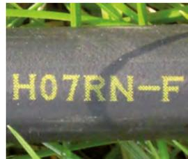
Besonders bei kalter Witterung macht sich der Unterschied bemerkbar: Kabel, die für draußen zugelassen sind, bleiben geschmeidig und vertragen auch mechanische Belastungen wie Verbiegen oder Reiben. Mit einfachem Kunststoff isolierte Kabel werden dagegen steif und können bei Belastung Schaden nehmen. Ein beschädigtes Kabel muss ausgetauscht oder in einem Fachbetrieb instandgesetzt werden.
